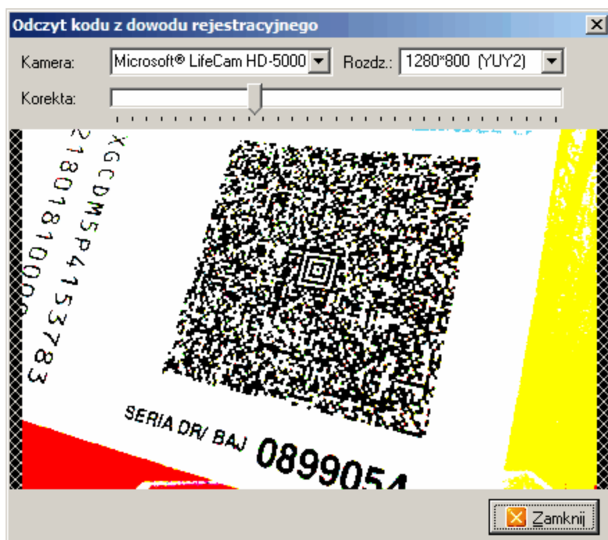
Rys. 6 kamera nie ustawiona prostopadle i zbyt blisko kodu - optymalna odległość to ok 7-9 cm
